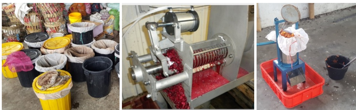
圖 20: 不同的脫水方法：重力被動脫水（左），螺旋壓榨機（中），榨汁機（右），（螺旋壓力機照Vincent公司提供）
