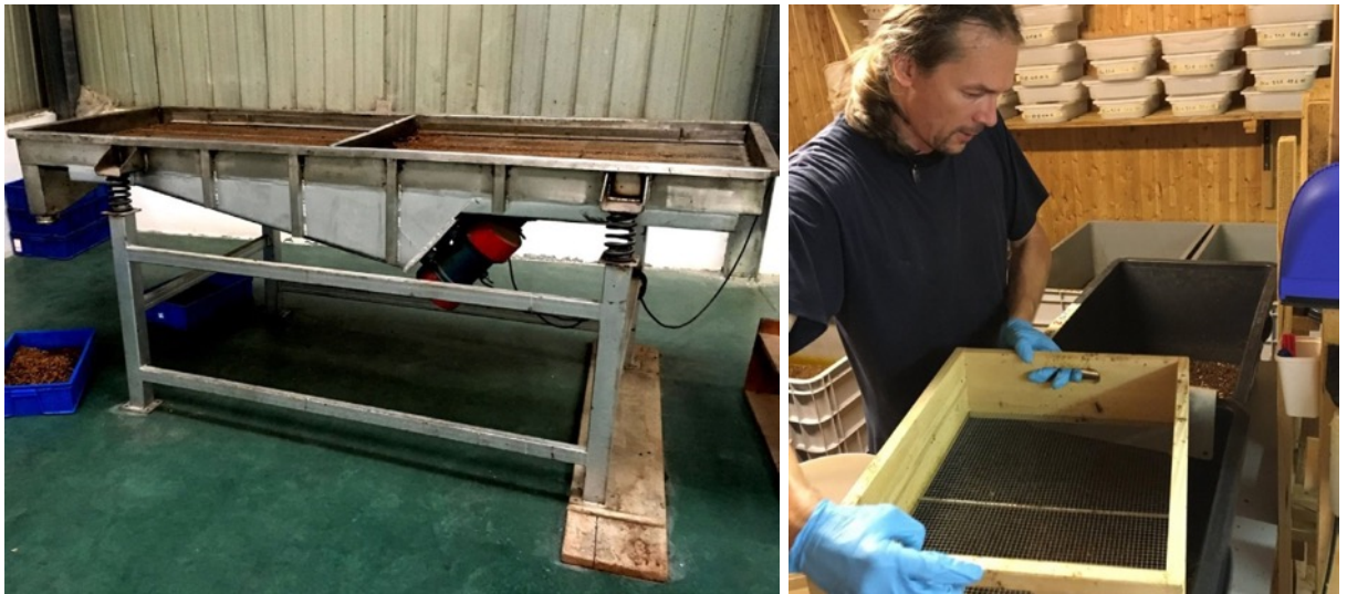
圖 17: 自動篩子（左）和手動篩子（右）將幼蟲與乾燥殘餘物分開
