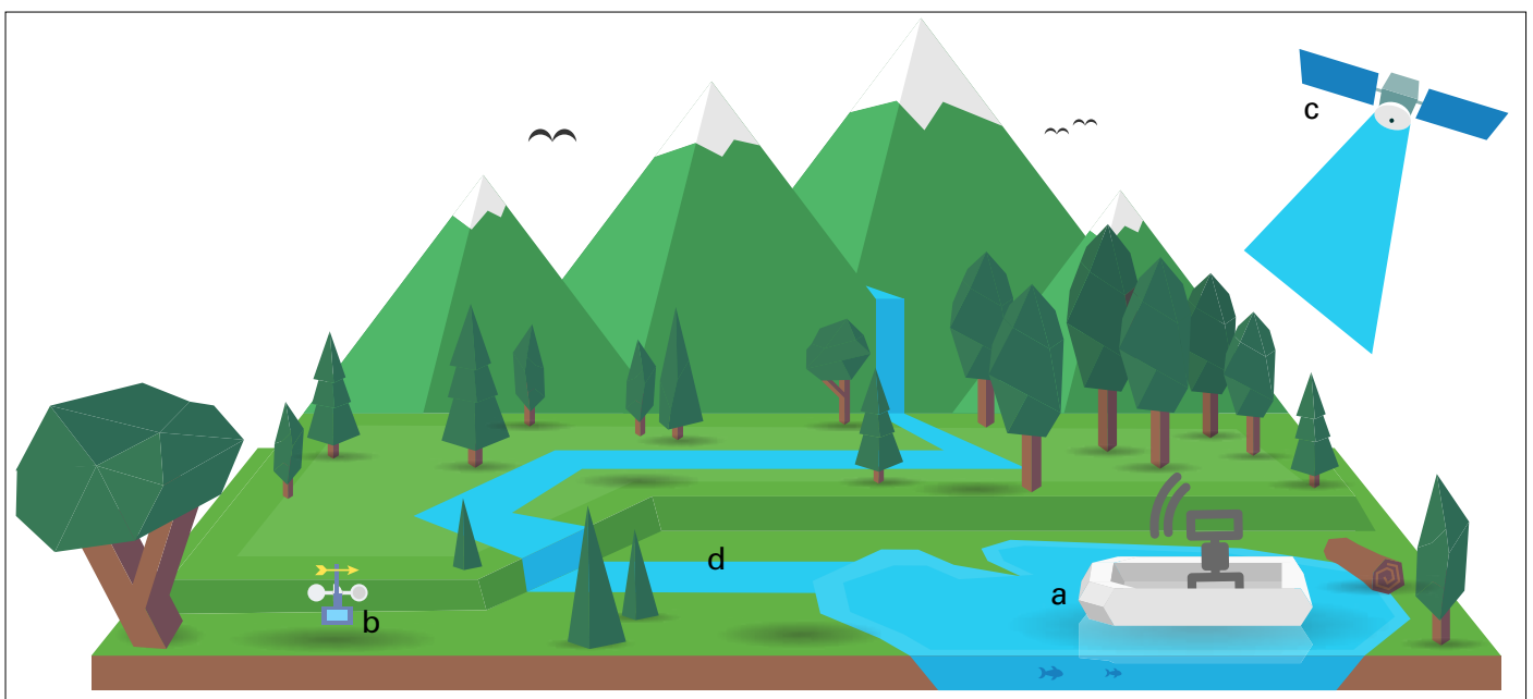
Zu den in «Datalakes» verfügbaren Daten gehören a) In-situ-See-Messungen, b) Daten von meteorologischen Sensoren, c) Satelliten-Fernerkundungsdaten und d) hydrologische Daten. (Quelle: https://datascience.ch )
