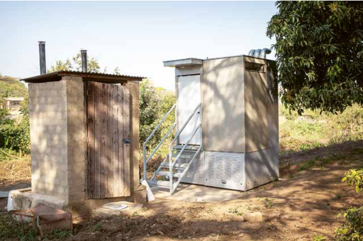
Im Bild Feldtest der Blue Diversion Autarky Toilette (rechts) neben einer bestehenden Trockentoilette mit Urinseparierung in einem Garten in Durban.
