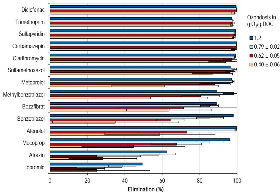
*Eliminationsleistung der Ozonung für einige ausgewählte Stoffe vom Röntgenkontrastmittel Iopromid über Biozide (Atrazin, Mecoprop etc.), Korrosionsschutzmittel (Benzotriazol) bis zum Antibiotikum Trimethoprim und dem Schmerzmittel Diclofenac.*
