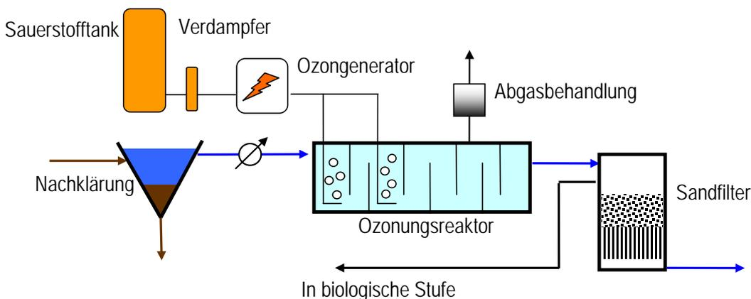
*Ablaufschema einer am Ende der bisherigen Abwasserreinigung nachgelagerten Ozonung zur Eliminierung von Mikroschadstoffen.*
