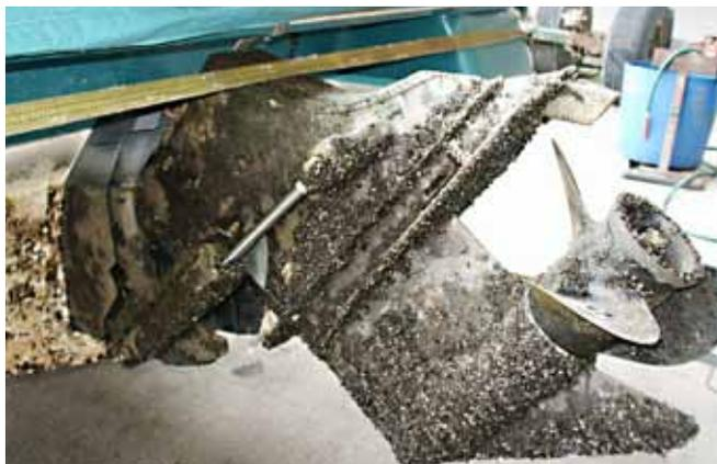
Abb. 2: Motor eines Bootes aus dem Zürichsee, das stark mit Wandermuscheln überwachsen ist. (Foto: Nora Weissert)
