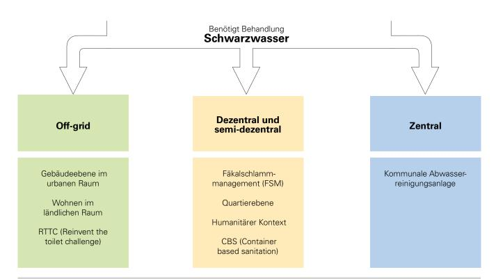
Off-grid: Es werden innovative off-grid-Lösungen entwickelt, um Schwarzwasser direkt an der Quelle zu behandeln (onsite). Dadurch entfällt der Transport zu einer externen Reinigungsanlage und das Ressourcenrückgewinnungspotential wird erhöht.
