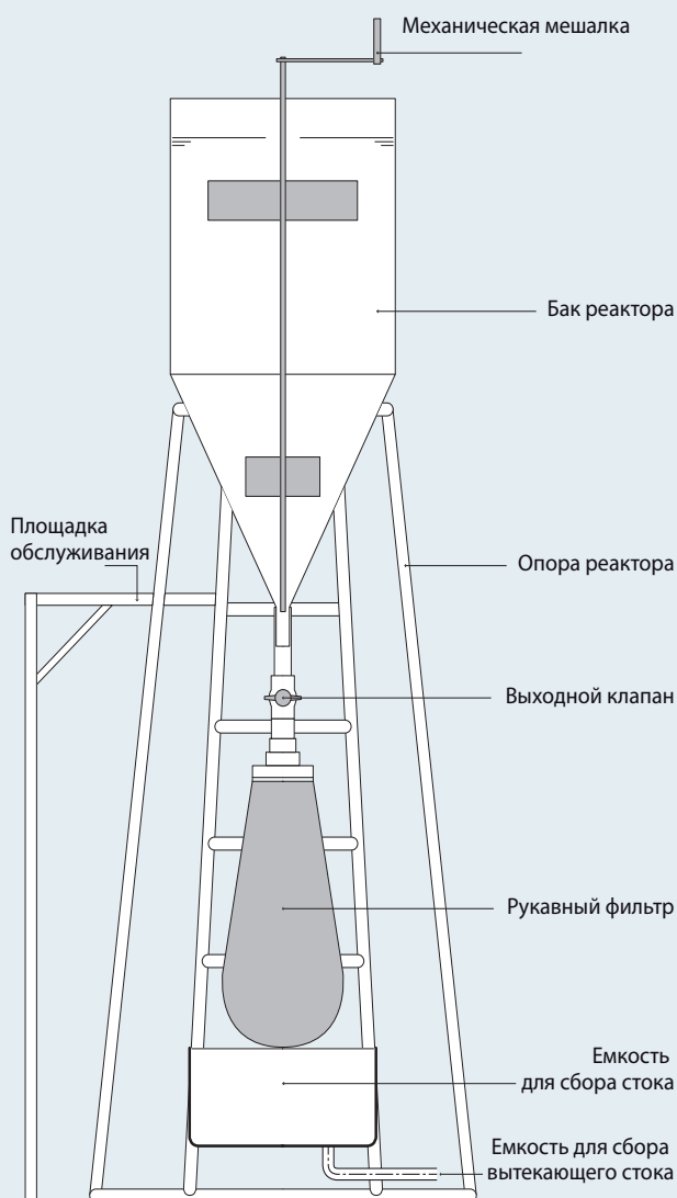
Рисунок 7: Схема реактора для производства струвита, оснащенного механической мешалкой и рукавным фильтром
