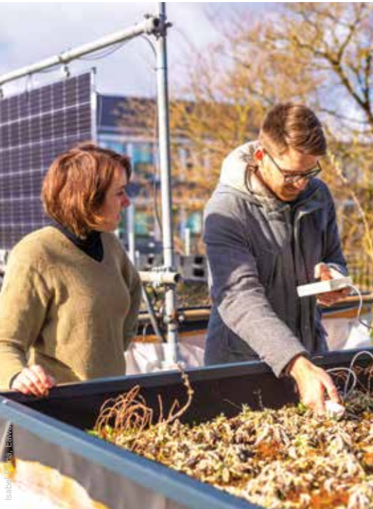
Welche Dachbegrünung kann am meisten Hitze reduzieren? Das und mehr hat Lauren Cook in einem Experiment untersucht. Zusammen mit Doktorand Giovan Battista Cavadini misst sie hier die Verdunstung des Woll-Ziest auf einem der Gründach-Modelle.
