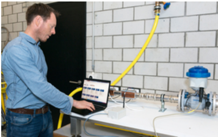
Dr. Frank Blumensaat (Abteilung Siedlungswasserwirtschaft) misst mit Adawim drahtlos den Wasserdurchfluss in der Versuchsanordnung. (Foto: Patrick Cipriani / ZHAW)
