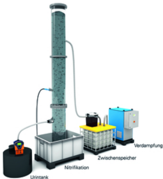
Abb. 2: Die im Projekt «Vuna» entwickelte Technik zur Separierung und Aufbereitung von Urin wird auch bei «Water Hub» eingesetzt. Eine Nitrifikations- und Verdampfungsanlage wandelt den getrennt gesammelten Urin mitsamt seinen Nährstoffen in einen Dünger um. (Bild: Eawag)
