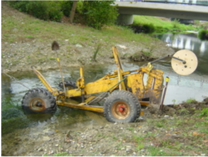
Abb. 2: Spezialpflug zum Verlegen des
