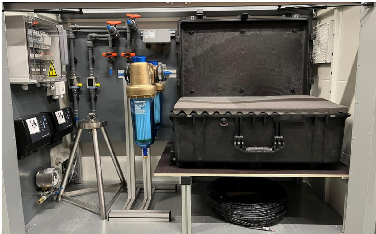
In der Box an der Oberfläche befinden sich die Sensoren zusammen mit dem Massenspektrometer GE-MIMS (Mini-Ruedi) (Foto: Eawag, Joaquin Jimenez-Martinez).
