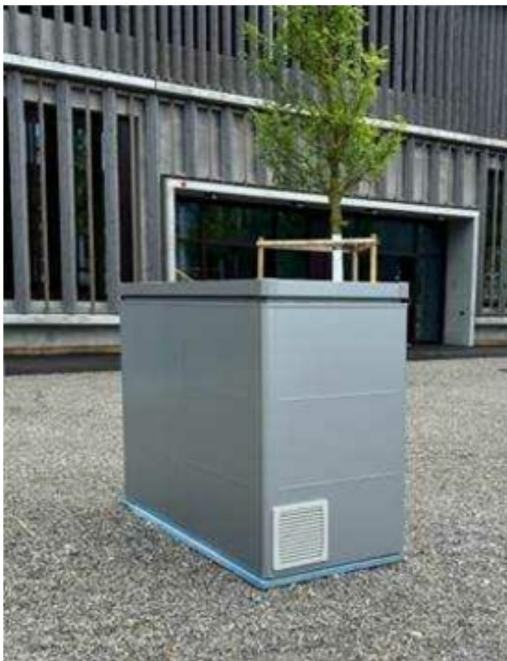
Auf dem Areal des Empa Eawag Campus stehen nun drei Boxen, ausgestattet mit Sensoren und je einem Massenspektrometer. Unter ihnen führen die Grundwasser-Pumpen 30 und 70 Meter in die Tiefe (Foto: Eawag, Joaquin Jimenez-Martinez.)
