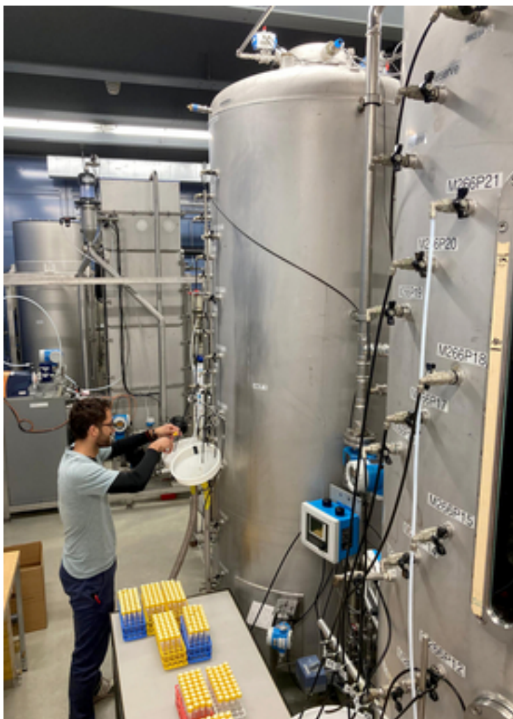
Filtrationskolonne im Eawag-Labor (links) und im Pilotmassstab im Seewasserwerk der Wasserversorgung Zürich WVZ (rechts). (Fotos: Eawag)
