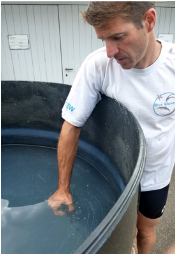
Nach dem Bad entnehmen die Forschenden Wasserproben, um diese auf künstliche Titandioxid-Nanopartikel aus der Sonnencreme zu analysieren.
