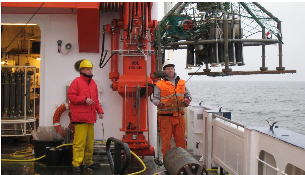
Mit Hilfe eines Multicorers sammeln die Forschenden Sedimentkerne. (©: Ryan North, Eawag)
