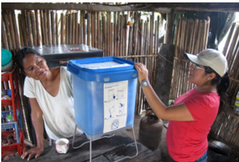
Prototyp des GDM-Haushaltsfilters im Feldtest in Peru. Mit einer Membranfläche von 0,5 m 2 kann der Filter bis zu 30 Liter Trinkwasser täglich bereitstellen – ohne Chemie und Filterreinigung. (Eawag)
