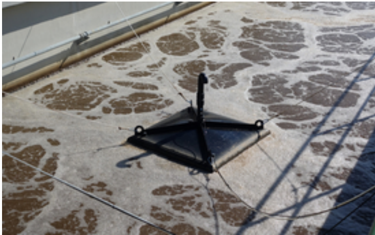
Abluftmesshaube im Einsatz in der ARA Birs. (Bild: Andrin Moosmann, Eawag)
