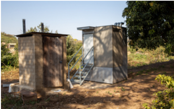
Die an der Eawag entwickelte «Autarky»-Toilette (rechts), welche die Stoffströme Wasser-Urin-Fäkalien gleich an Ort aufbereitet im Feldtest in Durban/Südafrika neben einer Trockentoilette. (Foto: Lucky Lugogwana)
