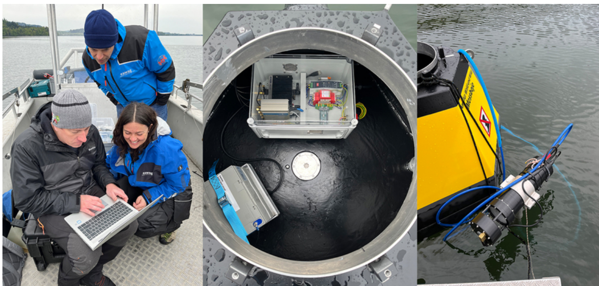
Links: Paul Roberts von der Monterey Bay Aquarium Research Institution kalibriert die Geräte. Mitte: Blick ins Innere der Boie. Rechts: Die Unterwasserkamera Aquascope (Fotos: Eawag).
