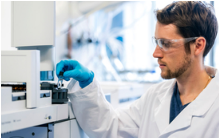
Selektive und nachweisstarke Analyse der Pyrethroidinsektizide in den Probenextrakte mittels Tandem-Massenspektrometrie gekoppelt an die Gaschromatographie. Im Bild: Michael Patrick, Wissenschaftlicher Assistent, Abteilung Umweltchemie, Eawag. Foto: Alessandro della Bella, Eawag
