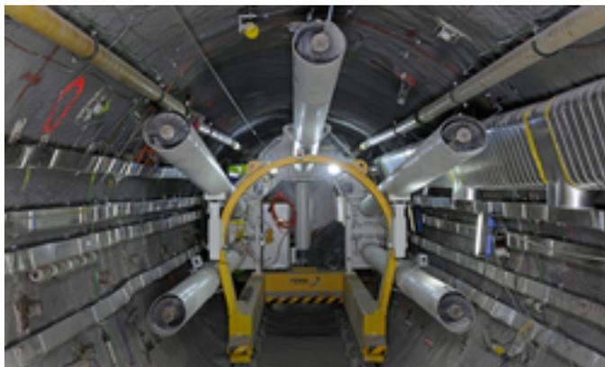
Blick in den FE-Versuchstunnel. Im Vordergrund sieht man einen Endlagerbehälter, der dank eines integrierten Heizelements wie ein echter künftiger Behälter von verbrauchten Brennelementen Wärme abstrahlt. Die zigarrettenförmigen Röhren sind Teil der Maschine, die zum Verfüllen des Tunnels benutzt wurde; durch sie fliesst der Bentonit an die richtige Stelle. (Foto: Nagra)
