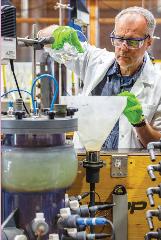
In ihrer Versuchskläranlage in Dübendorf optimieren Eawag-Forschende laufend Abwassersysteme, damit Verunreinigungen besser entfernt und Ressourcen zurückgewonnen werden können.
