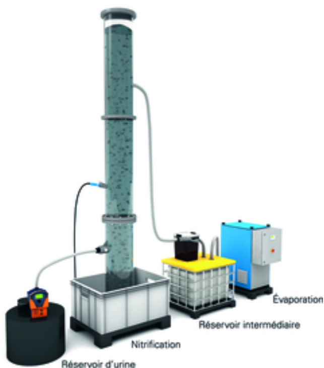
Fig. 2 : La technique de séparation et de traitement de l'urine mise au point dans le projet « Vuna » intervient également dans le projet « Water Hub ». Les urines collectées séparément sont transformées en engrais par un système de nitrification et d'évaporation. (Illustration : Eawag)
