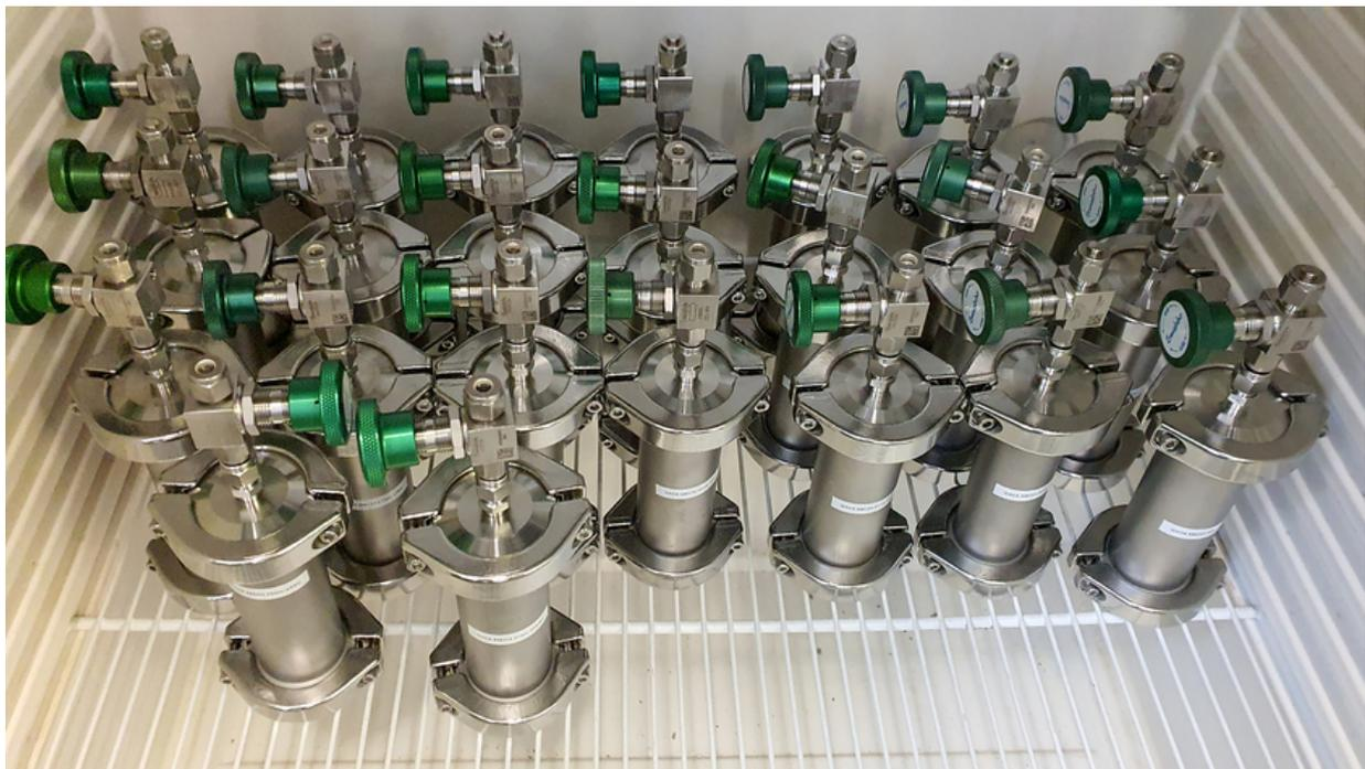
Sections du carottage prêtes pour l'analyse de l'eau interstitielle avec le spectromètre de masse portable GE-MIMS, le «mini-Ruedi», développé à l'EAWAG (Photo: Yama Tomonaga, Eawag, Uni Basel).
