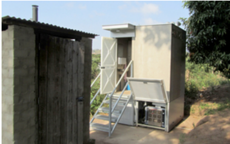
Les toilettes Blue Diversion Autarky en test à la périphérie de Durban, en Afrique du Sud. Le module d'évaporation est visible à l'avant droit. (Michel Riechmann, Eawag)
