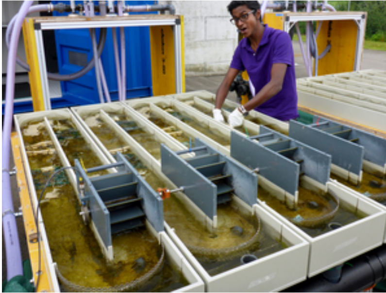
Fig. 4 : Les scientifiques ont étudié les effets de différents composants des eaux usées grâce à un système de 16 canaux expérimentaux. Photo: Eawag
