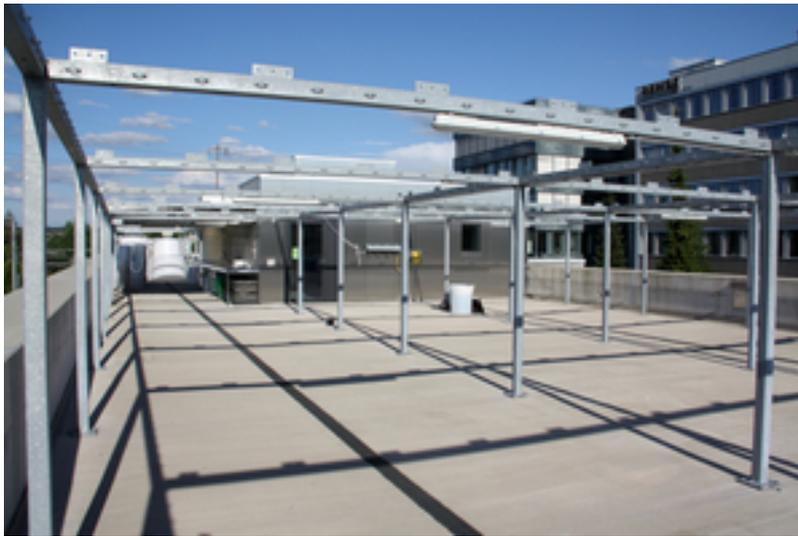
Toiture accessible pour des essais en plein air avec équipement pour l'ombrage des dispositifs
