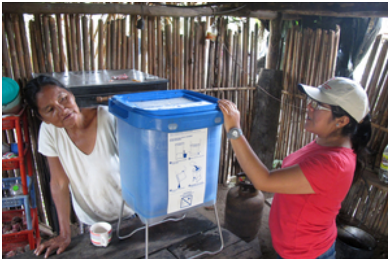
Prototypé du filtre ménager à GDMF dans un test au Pérou. Avec une surface de membrane de 0,5 m 2 , il peut produire jusqu'à 30 litres d'eau potable par jour – sans produits chimiques et sans nettoyage du filtre. (Eawag)
