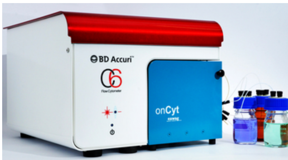
Fig. 2: Système entièrement automatisé de cytométrie de flux en ligne, composé d'un cytomètre de flux usuel (rouge/blanc) et d'un module d'automatisation développé de l'Eawag (bleu).
